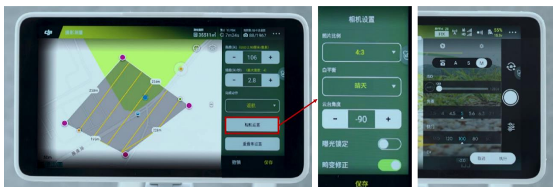
图4-5 采集正射影像数据时的无人机参数
